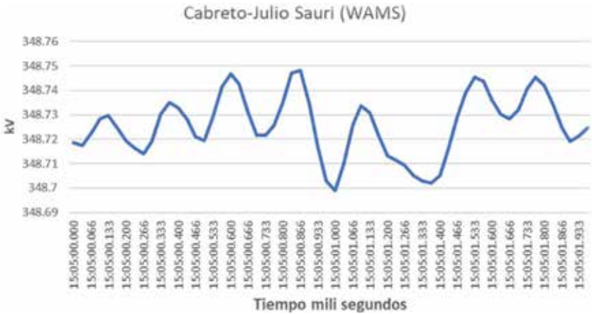
Figura 6 Registro de voltaje Barra Cabreto-Julio Sauri mediante WAMS
