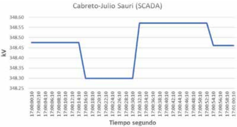
Figura 5 Registro de voltaje Barra Cabreto-Julio Sauri mediante SCADA
